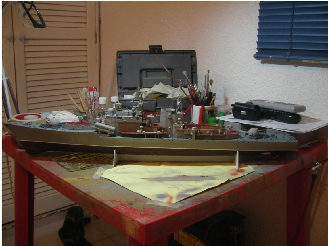
En este paso ya se encuentran montadas las dos cubiertas medias, el edificio secundario de mando de proa y el cañón del mismo lado, así como los lanzamisiles
