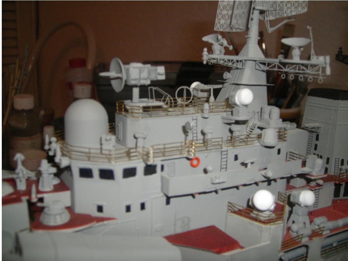
El edificio principal de mando se detalla con los barandales de fotocortado y las escaleras de tipo marino, las ventanas son rellenas con un plumón de tinta indeleble
